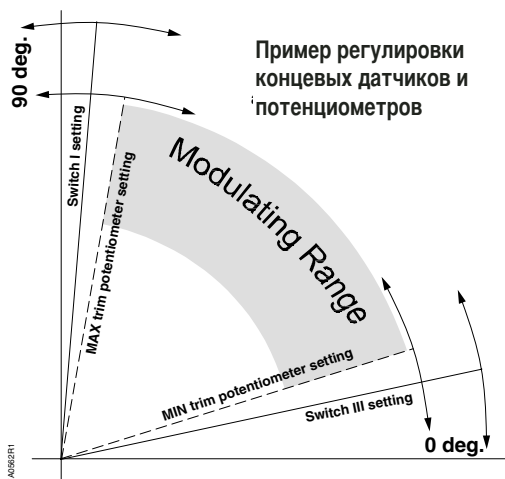
Рис. 13. Установка кулачков и подстроечных потенциометров.
